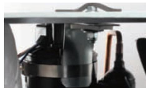
Компрессор фиксируется сверху и снизу, чтобы избежать вибрации.
